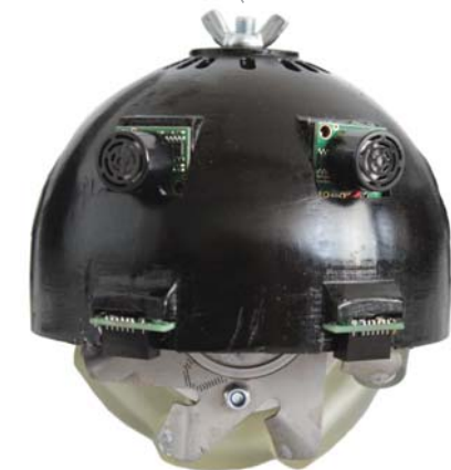
Ультразвуковые датчики расстояния для обнаружения препятствий и инфракрасные датчики для исключения падений робота.
