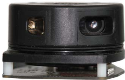
Однолучевой лазерный сканер с углом обзора 360 градусов и точностью измерения 2 см в диапазоне от 0,5 м до 6 м, с частотой 5 Гц.
