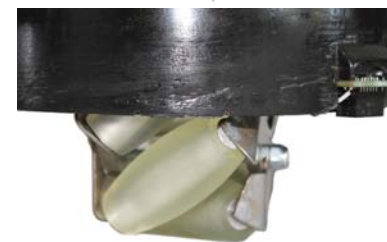
Интегрированное мотор-омниколесо (с полиуретановыми роликами) с двигателем постоянного тока и энкодером.
