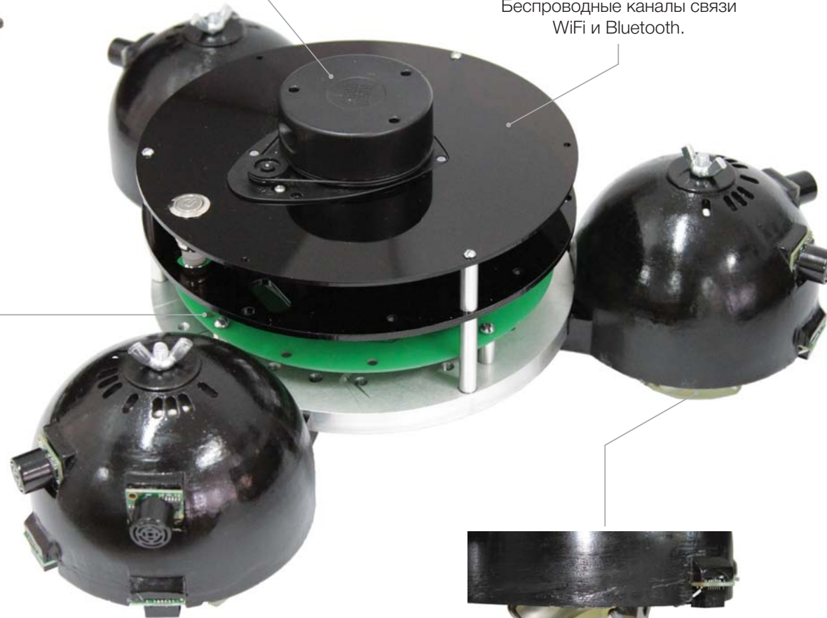
Однолучевой лазерный сканер с углом обзора 360 градусов и точностью измерения 2 см в диапазоне от 0,5 м до 6 м, с частотой 5 Гц.
